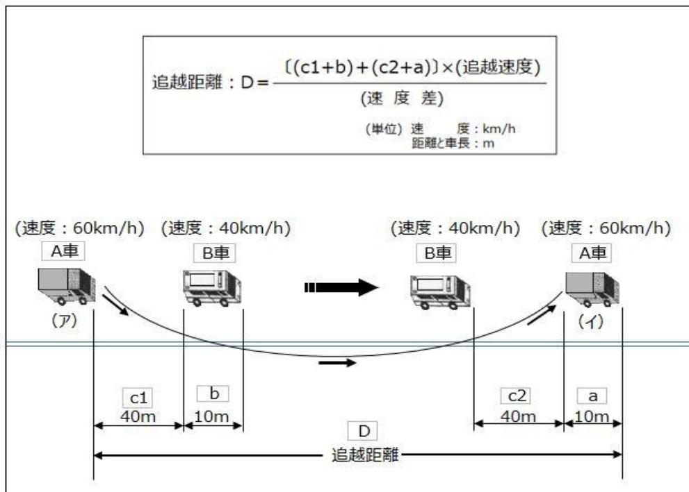
1. 一般道を車両の長さ 10 メートルの A 車が時速 60 キロメートルで走行中、上図のとおり、時速 40 キロメートルで前方を走行中の車両の長さが 10 メートルの B 車を追い越すために要する追越距離を次の①～②の中から正しいものを 1 つ選びなさい。
